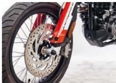
Vorne liefert die Doppelkolbenzange und die große, gelochte Bremsscheibe eine beeindruckende Bremsleistung
