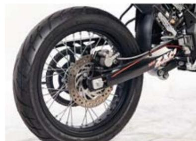
Einstellbares Zentralfederbein, Stahlflex - Bremsleitungen und kräftige Scheibenbremsen bei Supermoto- und Enduroversion
