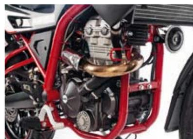
Das starke DOHC Triebwerk ist beim Scrambler in einem stabilen Doppelschleifenrahmen verbaut
