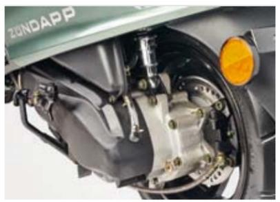
Die 125cm<sup>2</sup> Version verfügt über ein CBS Bremssystem mit Stahlflexbremsleitungen und Bremsscheibe hinten
